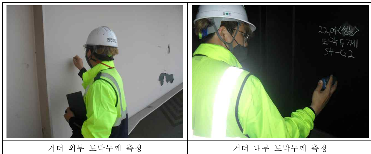
<그림 3.21> 도막두께 측정
