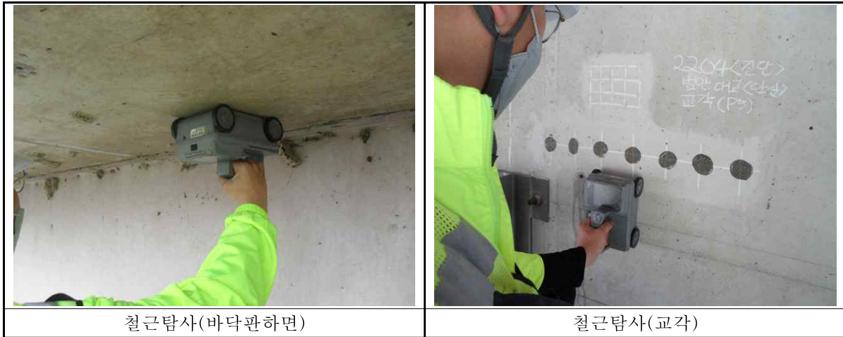
<그림 3.15> 철근탐사 시험
